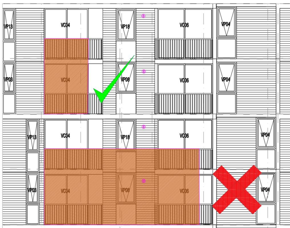
Ilustración 6: correcta instalación de banderas.
